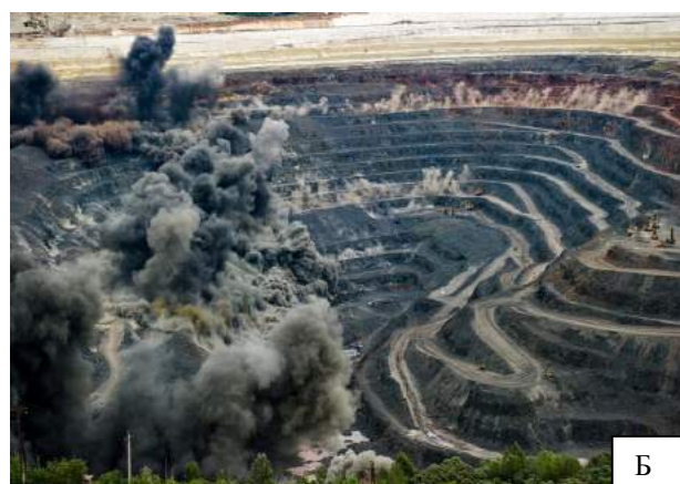
Рис. 4.7. Добыча железнорудного сырья: А - карьерные работы на СГОКе, Б - Буро-взрывные работы на карьере
